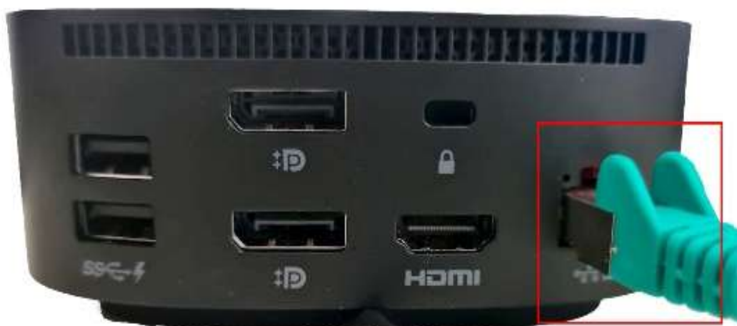
Abb. 23 Rückseite der USB-C-Dockingstation mit eingestecktem Netzkabel
