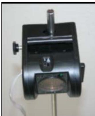
**Abb. 2: Ultraschallsensor**
