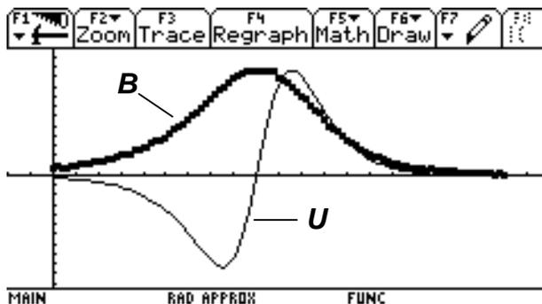
Gleichzeitige Messung von  $B$  und  $U$  beim Annähern und Entfernen eines Magneten
