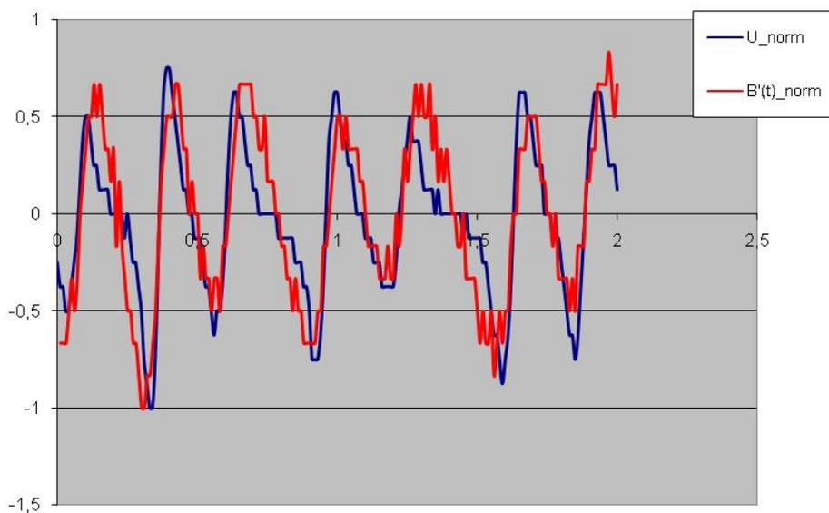
**Auswertung: Verlauf von  $B'_normiert$  und  $U_normiert$  beim leichten Schwingen eines Magneten über der Spule**
