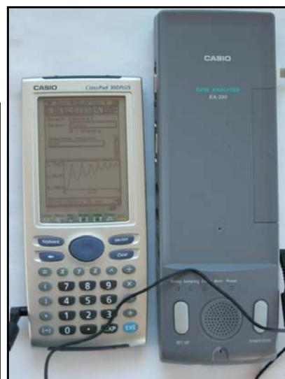
**Abb. 3: ClassPad 300 Plus und Messinterface EA 200**
