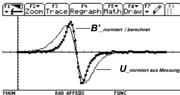
**Auswertung: Verlauf von  $B'_normiert$  und  $U_normiert$  beim Annähern und Entfernen eines Magneten**
