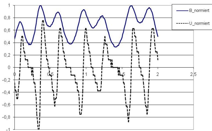
**Gleichzeitige Messung von  $B$  und  $U$  (normiert) beim leichten Schwingen eines Magneten über der Spule**
