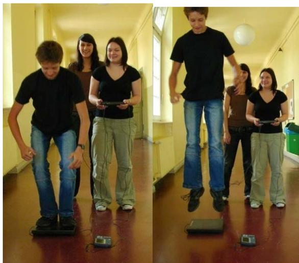
**Versuchsaufbau: Sprung auf der Kraftplatte**
