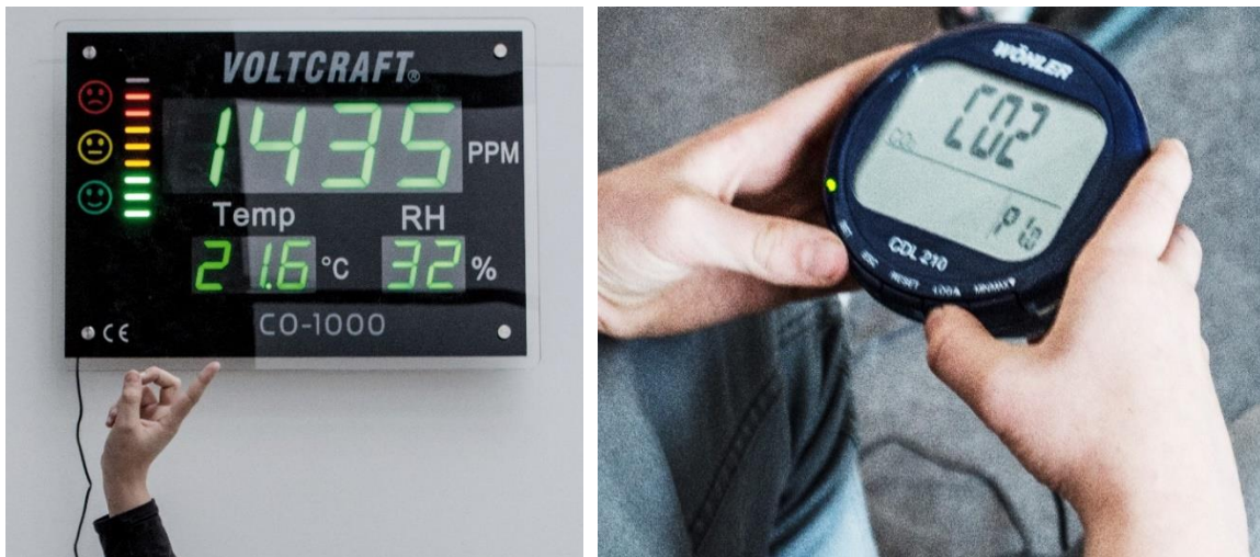
Abbildungen 5 und 6: Große Messdisplays (li.) haben erwiesenermaßen einen Aufforderungscharakter und motivieren zum Lüften. Mit Datenloggern (re.) lassen sich CO 2 - und Temperaturverläufe aufzeichnen und das Lüftungsverhalten analysieren. 2
