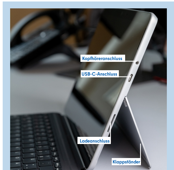
Abb. 3 Bildschirm mit ausgeklapptem Ständer, Ladeanschluss, USB-C-Anschluss und Kopfhöreranschluss
