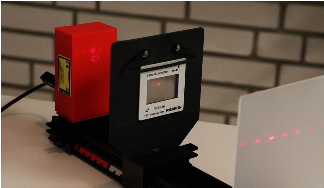
Abbildung 2: Mit einem 3D-Drucker selbst hergestelltes Gehäuse passend zu der optischen Bank einer Lehrmittelfirma für einen preiswerten Laser der Klasse 1. Das anpassbare Tinkercad-Modell hat dankenswerterweise Rayk von Ende (Barnim-Gymnasium) frei zur Verfügung gestellt ( https://www.tinkercad.com/things/jrUAqWodnLQ-laserhalterung ). 2
