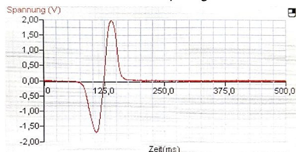
Abbildung 15: Messzeit 500 ms und Vorspeicherung 125 ms. Es ist erkennbar, dass die Messzeit auf 250 ms verkürzt werden kann. 18
